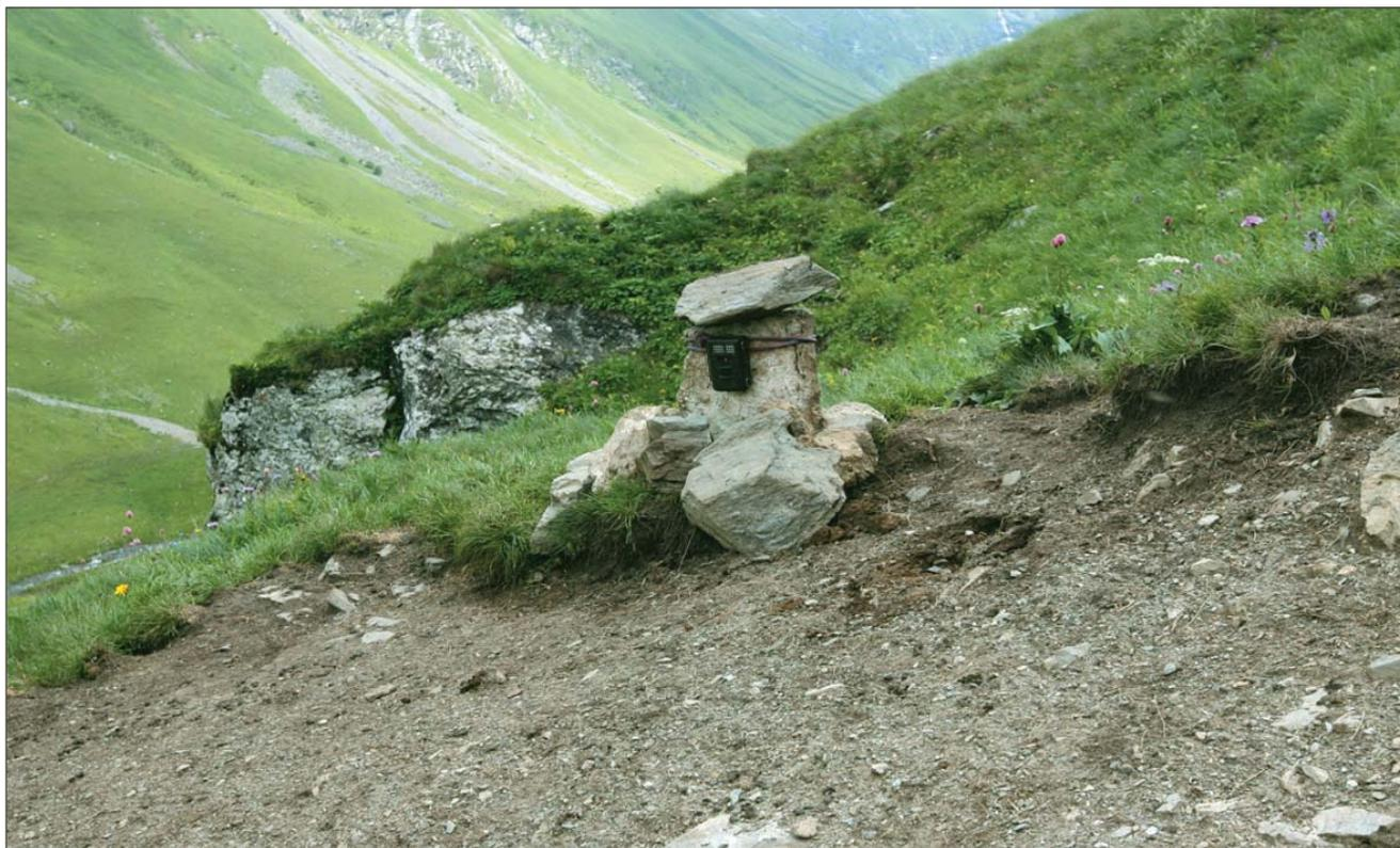
**Фото 18.** Фотоловушка устанавливаемая на солонце. Она должна быть установлена таким образом, чтобы угол обзора был максимальным, а в случае снегопада, чтобы зимой она не была засыпана снегом.
