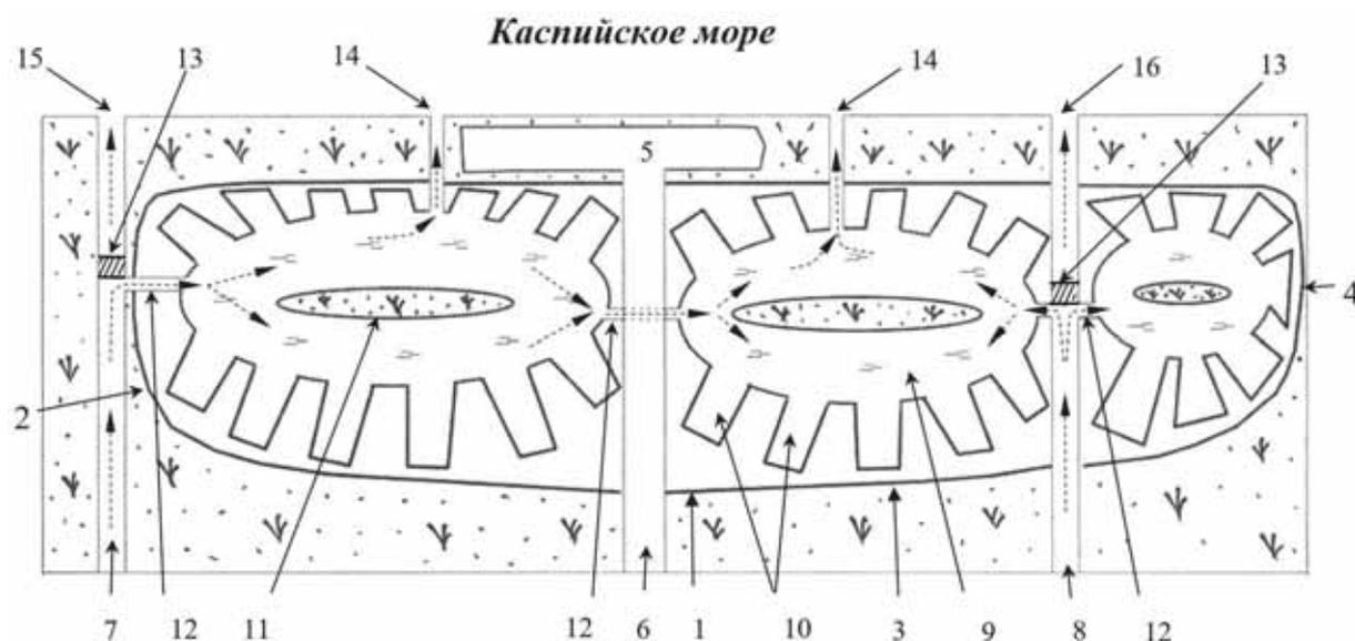
Рисунок 6 – Схема гидрологической реконструкции Туралинской лагуны.
