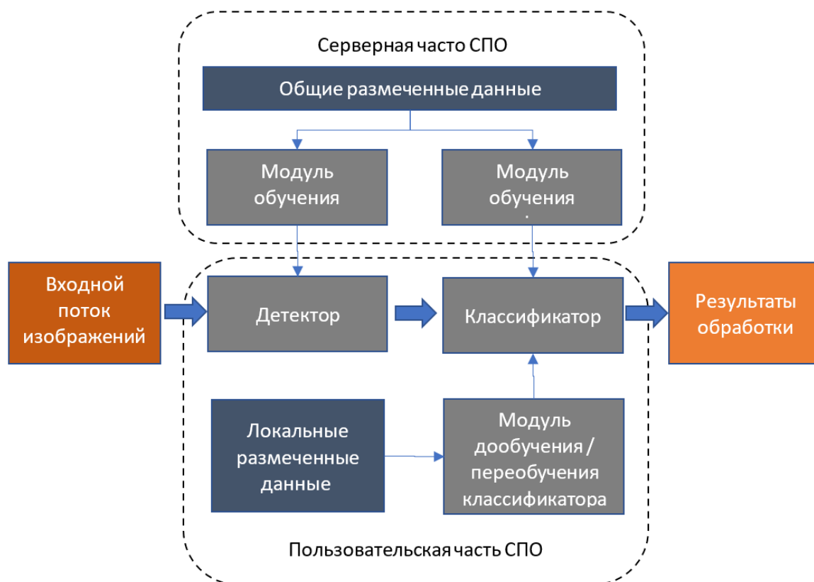
Рис. 3. Общая схема работы ПО. Fig. 3. General scheme of software.
