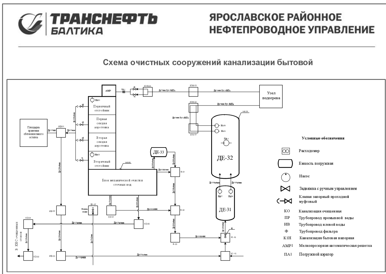
Рис. 3. Технологическая схема очистных сооружений ХБСВ
