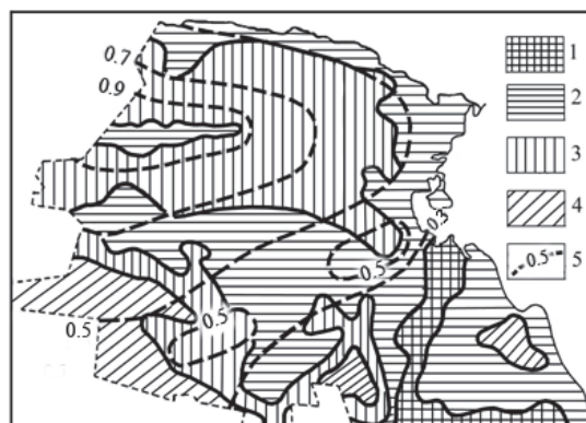
Рис. 4. Схематическая карта снижения уровня грунтовых вод. Глубина залегания уровня грунтовых вод: 1 – от 0 до 1м; 2 – от 1 до 3м; 3 – от 3 до 5м ; 4 – от 5 до 10м . 5 – расчетная величина снижения уровня грунтовых вод (м).
