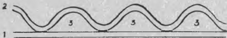
Рис. 11. Поперечный разрез участка крыши: 1— обрешетка; 2— кровля из гофрированного шифера; 3— ходы, по которым скворцы проникают на чердак
