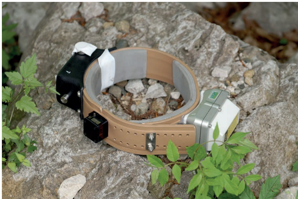
Рис. 19. Ошейник модели Iridium Track M Collar 1D фирмы Lotek, Канада с укрепленными на нем батареей, блоком, включающим GPS, передатчики Iridium и УКВ, и само-сбросом.
