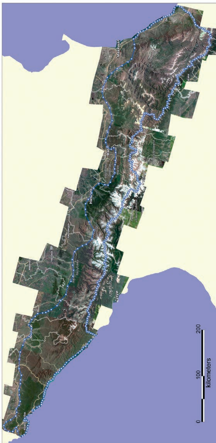
Рис. 10. Общий вид безоблачной мозаики, собранной из космоснимков, полученных за 7 лет съемки, для российской части Кавказа, смежной с Главным Кавказским хребтом. Корректно созданная мозаика определяет выбор обзорных массивов данных для последующего моделирования потенциального ареала леопарда.
