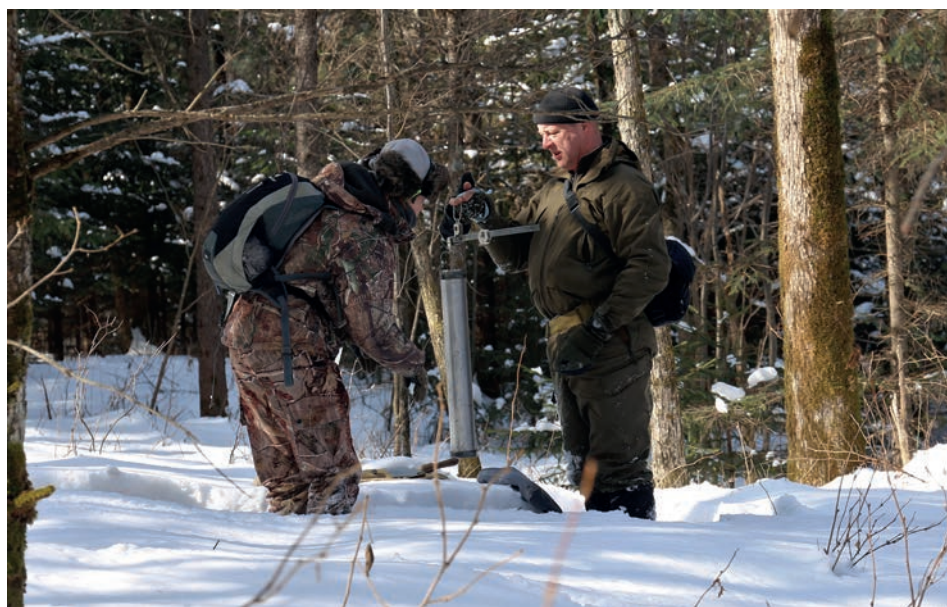
Рис. 15. Снегомерные работы включают отбор пробы в стандартный снегомерный цилиндр, взвешивание массы снега (она зависит от его плотности и объема) и оценку мощности (толщины снегового пласта).
