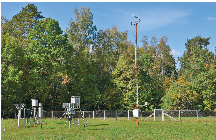
Рис. 3. Автоматическая метеостанция на пробоотборном полигоне станции КФМ «Приокско-Тerrasный БЗ». Фото В.В. Горбатовского
