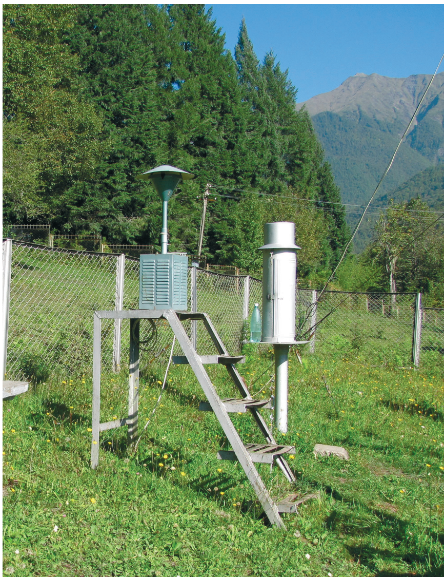
Рис. 1. Электроаспиратор «Кипарис» на станции КФМ «Кавказский биосферный заповедник». Фото Ю.А. Буйволова
