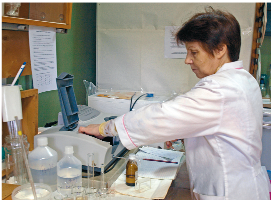
Рис. 4. Начальник станции КФМ «Приокско-Тerrasный БЗ» В.А. Аблеева в лаборатории проводит измерения загрязнения воздуха методом фотоколориметрии. Фото Ю.А. Буйволова
