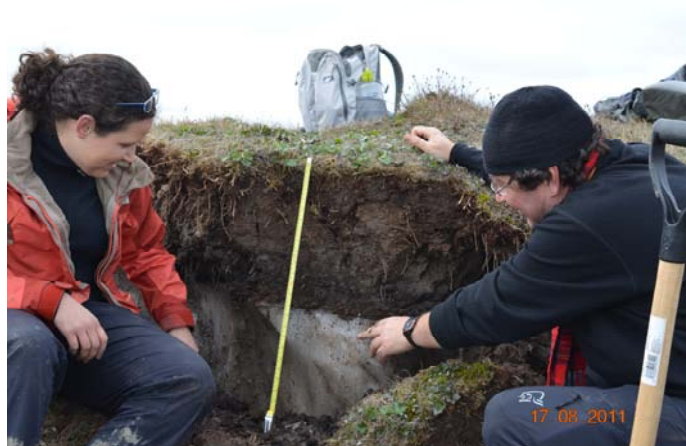
Рисунок 6.2 - Анализ вертикального разреза многолетнемерзлых пород, содержащих ледяные жилы.
