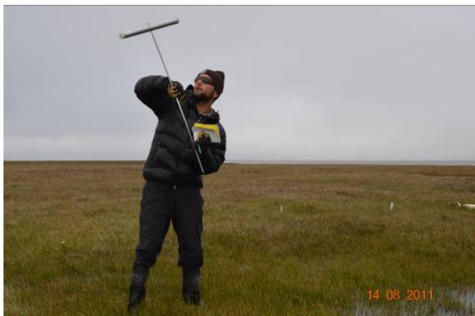
Рисунок 6.1 - Измерение мощности сезонно-талого слоя при помощи ручного щупа
